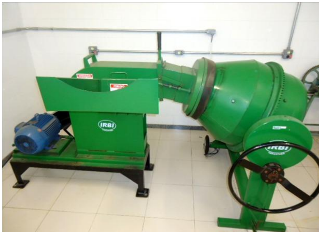
Figura 4. Adaptação de uma betoneira para homogeneização da cana desfibrada.
