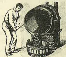
Fig. 4 — Apparelo "Deroy" para cozinhar alimentos com dispositivo para bascular o caldeirão
